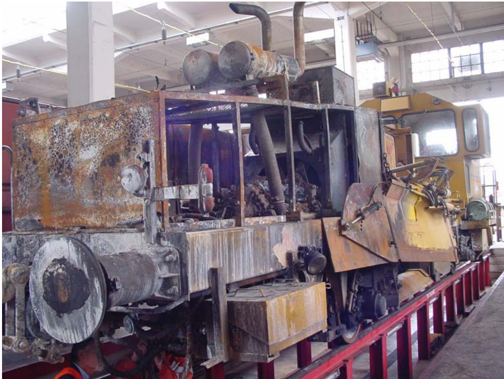
Régaleuse ,Scheuchzer P 523', partiellement incendiée, photographiée au dépôt de Bienne
